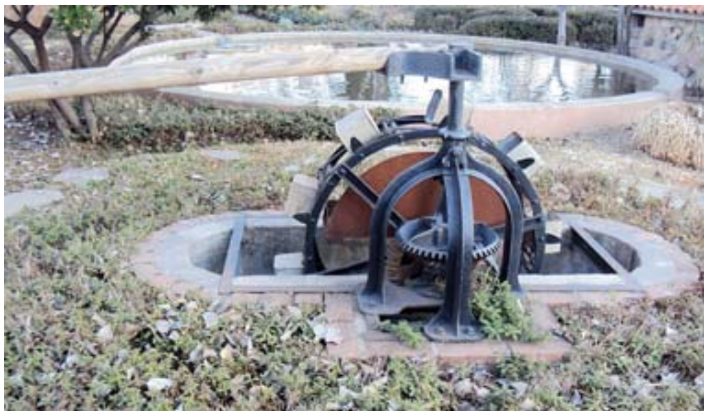
Noria de cangilones restaurada. La fuerza de un burro ó mula, que se movía describiendo círculos con centro en el eje de la noria, hacía posible la extracción del agua de un pozo de no más de 6 metros.
